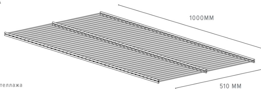
! Устанавливается на раму стеллажа серии LWS3F, LWSA5F, LWS7F при помощи нового аксессуара L6177.
